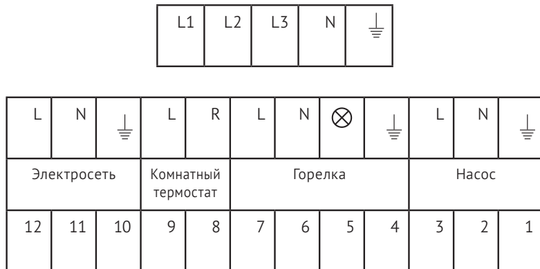
Рис.9. Вид со стороны подключений на панели управления котла ЕКО ЕL
