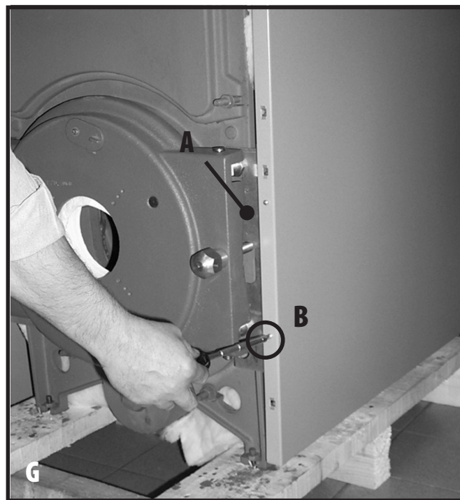
G Прикрепите боковину к скобе "А" и зафиксируйте ее винтами "В" (вид справа).
