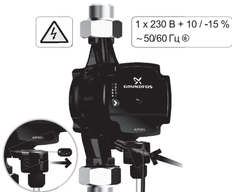
Рис. 9 Подключение сигнального кабеля к ALPHA1
