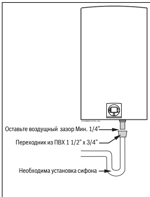
Рис. 27 Установка трубопровода слива конденсата
