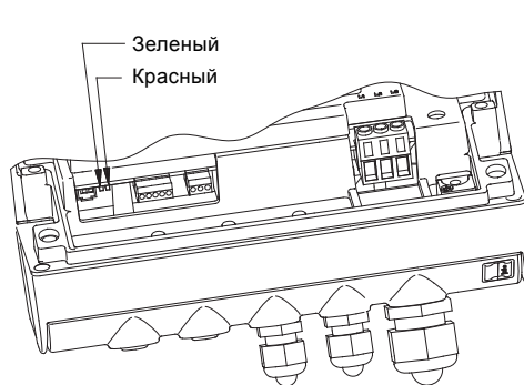
Рис. 37 Световые индикаторы на насосах с однофазными электродвигателями
