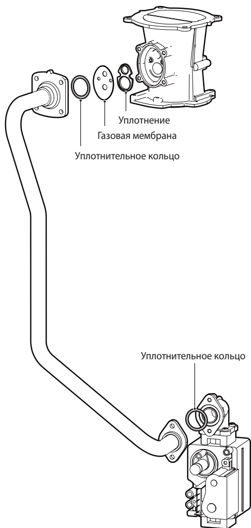
Рисунок 5-2. Газовый узел в разобранном виде (NCB 700-35K)
