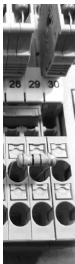
Рис. 7 Пример установки сопротивления (резистора)
