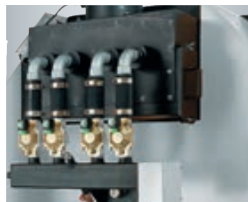
Пневматическая система очистки дымогарных труб
