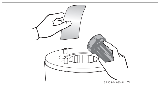
Рис. 52 Проверка наличия грязи в теплообменнике
