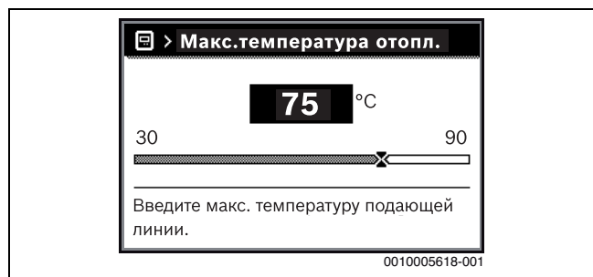
Рис. 7 Установка максимальной температуры подающей линии
