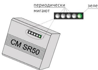
При штатной работе на датчике наполнения горит один зелёный диод, а остальные мигают в зависимости от количества пеллет, которые подаются через гибкую трубку в пеллетную горелку
