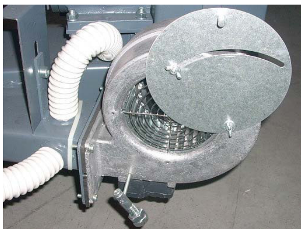
Положение макс. открытой воздушной заслонки вентилятора
