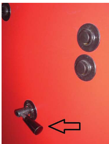
Положение рукоятки воздушной заслонки в режиме нормальной работы
