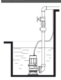
Перед началом установки убедитесь в том, что насос и электрический кабель не имеют повреждений и отсутствуют следы утечки масла, проверьте сопротивление изоляции двигателя - оно должно быть не менее 50 МОм.
