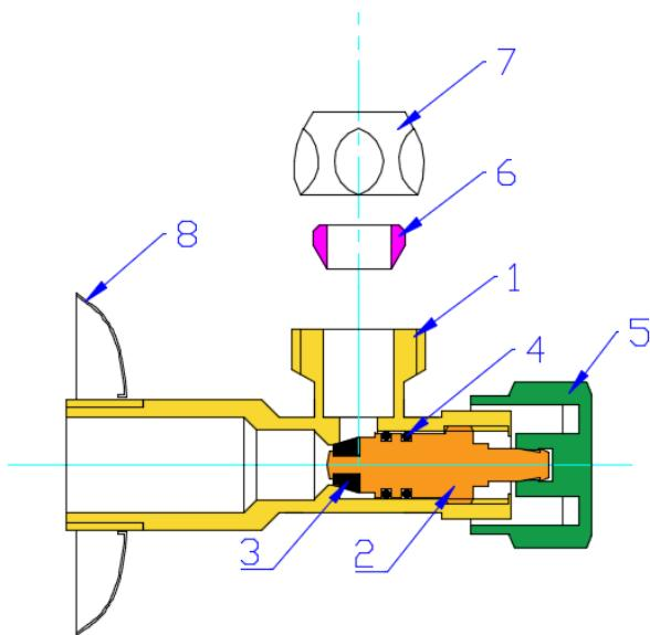
Корпус вентиля (1) выполнен из горячепрессованной латуни CW 617N с гальванопокрытием из хрома. Шток (2) изготовлен токарным способом из латуни CW 614N, и имеет интегрированный золотник из EPDM (3).
