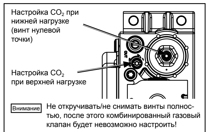
Комбинированный газовый клапан
