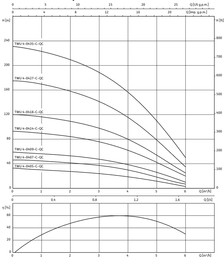
1~230 В или 3~400 В, 50 Гц,  $\rho = 1 \text{ кг/дм}^3$ ,  $\nu = 1 \times 10^{-6} \text{ м}^2/\text{с}$ , ISO 9906 приложение А,  $\eta$  = КПД насоса
