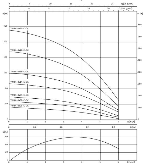
1~230 В или 3~400 В, 50 Гц,  $\rho = 1 \text{ кг/дм}^3$ ,  $\nu = 1 \times 10^{-6} \text{ м}^2/\text{с}$ , ISO 9906 приложение А,  $\eta = \text{КПД насоса}$
