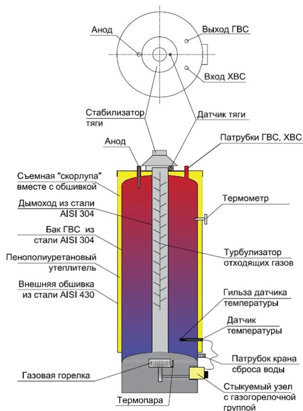
накопительного бака. Поэтому нагрев осуществляется не только в камере сгорания. Основной теплообмен проходит через трубу с отходящими продуктами сгорания.
