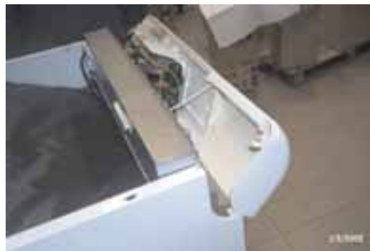
Рис. 6 - Поверните панель управления вперед.
