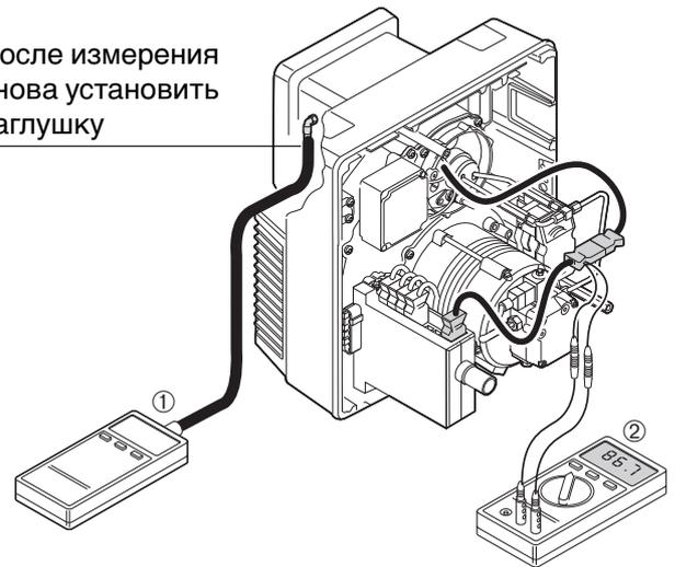
Прибор для измерения давления на топливном насосе (для ввода в эксплуатацию)
