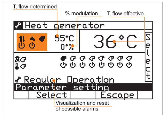
Выделенная часть показывает режим функционирования системы (Отгорление/ГВС) и генератора:
