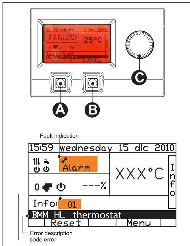
Когда котёл обнаруживает неполадку, знак аварийного сигнала отображается на дисплее с соответствующим кодом ошибки и описанием.
