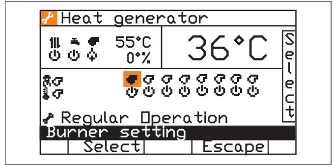
Выделенный участок показывает обнаруженные горелки и их режим функционирования:
