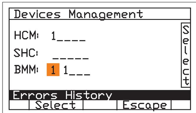
На дисплее показаны устройства, имеющиеся в установке ( - = не присутствует/1-8 = последовательный номер обнаруженного устройства
