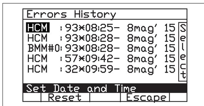
Отображаются путём выбора с управления устройствами (последние 6 ошибок). Сбросить для удаления Архива. В каждой строке указано: устройство, где возникла ошибка, код ошибки, время и дата.
