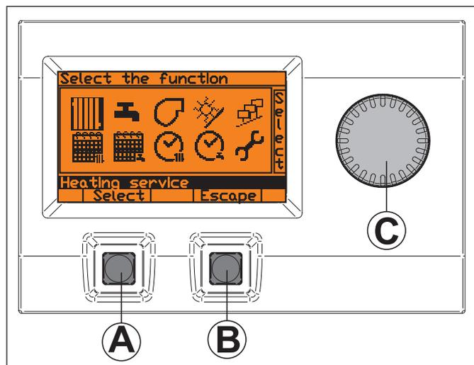
Блок управления представляет собой большой дисплей с двумя кнопками (А и В) и рукояткой С.
