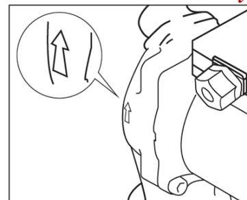
5.1. Направление движения теплоносителя должно совпадать с направлением стрелки на корпусе насоса.
