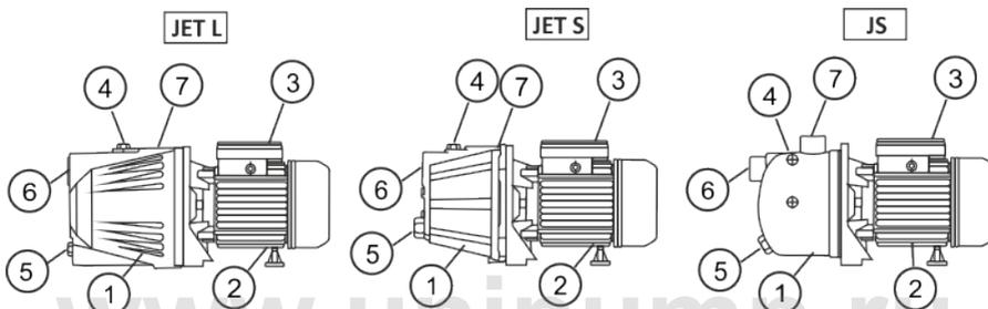
Насос состоит из следующих основных узлов: центробежного самовсасывающего насоса – (1), асинхронного электродвигателя – (2) и пускового устройства – (3). Насос имеет заливное – (4) и сливное – (5) отверстия, входное – (6) и выходное – (7) отверстия.
