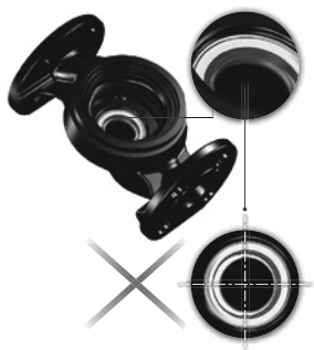
Рис. 16 Неправильно выровненная система уплотнений
