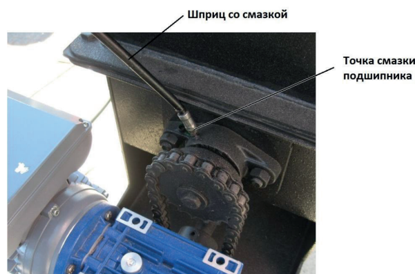
Рис. 8. Смазка подшипников шнековой подачи.
