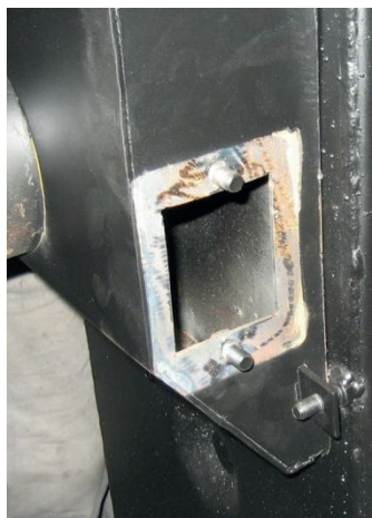
Рис. 10. Отверстие для чистки адаптера дыма.
