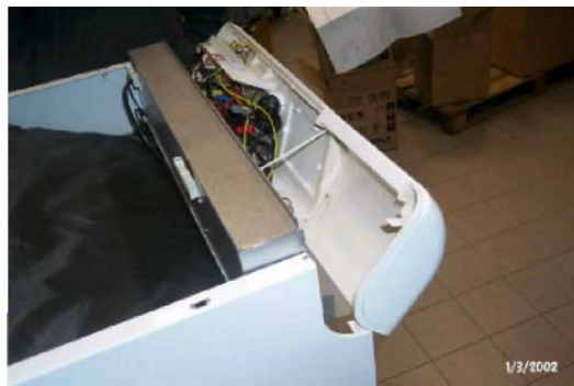
Рис. 6 – Поверните вперед панель управления.
