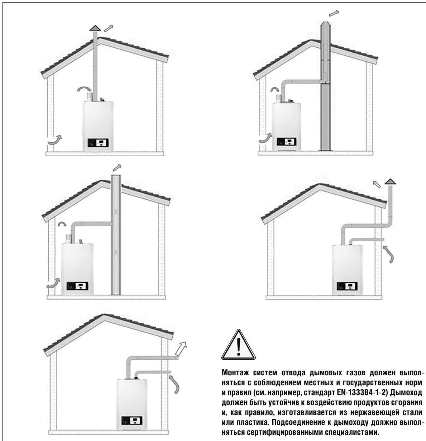
Для подсоединения котла к дымоходу используется труба из нержавеющей стали или пластика с соответствующим внутренним диаметром (в зависимости от модели), способная выдерживать длительные механические нагрузки, высокие температуры (<120°C) и химическое воздействие дымовых газов и продуктов конденсации. Для обеспечения возможности обслуживания рекомендуется выполнять соединения дымохода разъемными. Горизонтальные участки дымохода должны иметь уклон в сторону котла на менее 3°.
