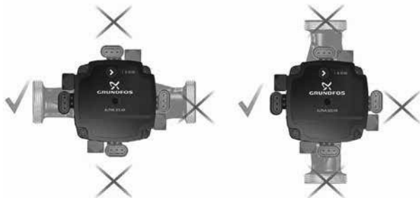
Рис. 3 Положение блока управления, ALPHA SOLAR
