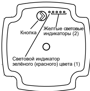
Рис. 6 Панель управления с кнопкой и пятью световыми индикаторами
