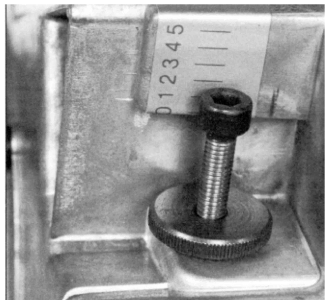
Рис. 4: Настройка воздушной заслонки
