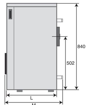
**Габаритные размеры котлов серии NORMA**
