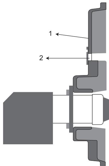
Рис. 11. Присоединительные размеры фланца горелки
