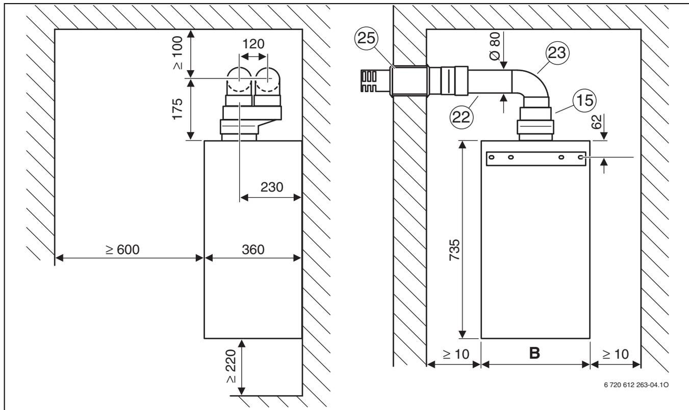
Рис. 8 Газоотводный трубопровод в соответствии с C<sub>12</sub>
