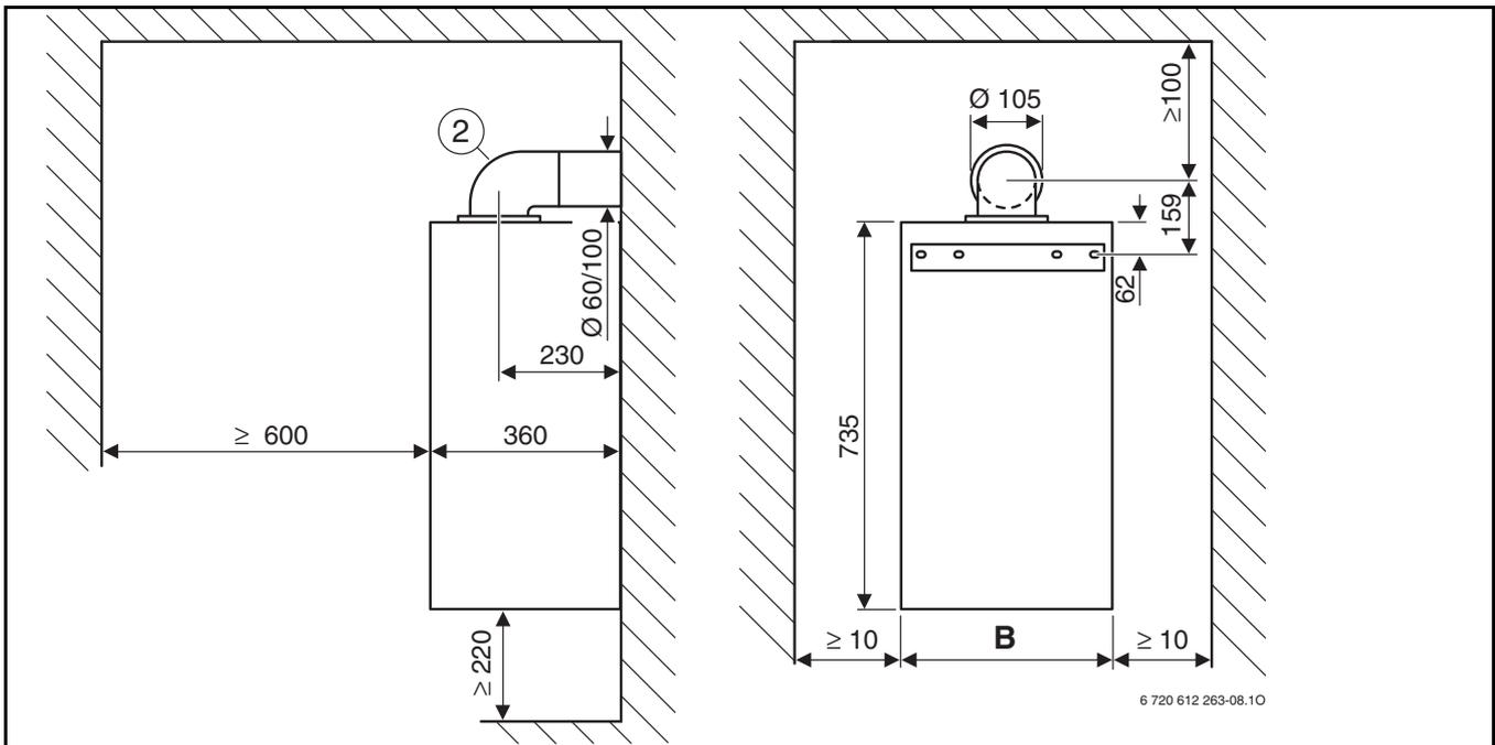
Рис. 2 Газоотводный трубопровод в соответствии с C<sub>12</sub>
