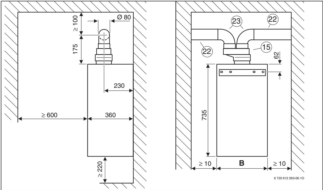
Рис. 10 Газоотводный трубопровод в соответствии с C<sub>42</sub>, C<sub>52</sub> и C<sub>82</sub>
