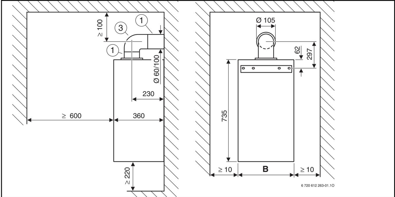
Рис. 1 Газоотводный трубопровод в соответствии с C<sub>12</sub>
