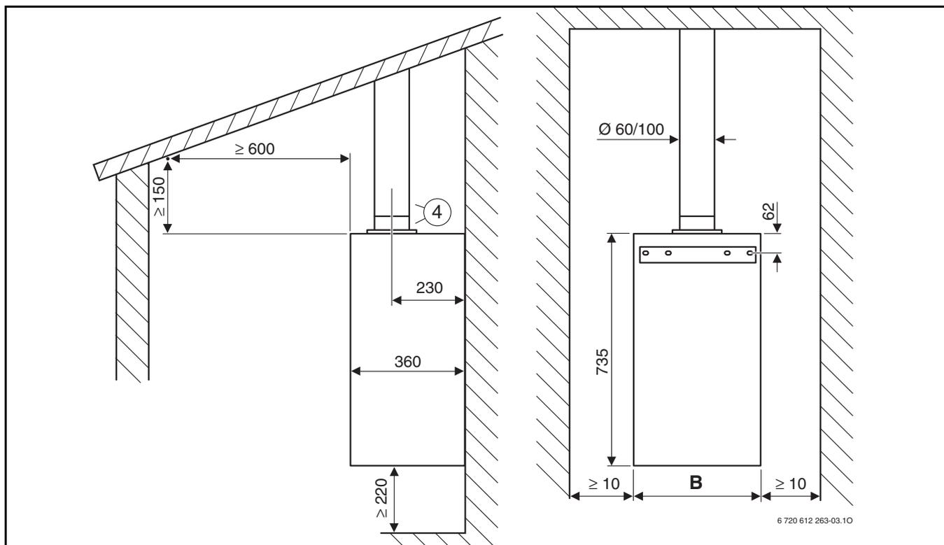
Рис. 5 Скатная крыша
