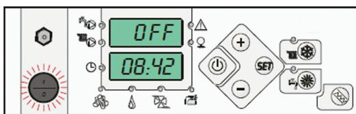
Включение пульта управления котла. При включении пульта управления с помощью главной кнопки, пульт управления находится в фазе OFF, то есть горелка не работает. На верхнем экране появляется надпись OFF, а на нижнем – попеременно появляется настоящее время и температура воды в котле.
