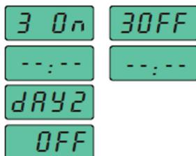
Подпрограмма Pr05: Установка третьего включения/выключения.
