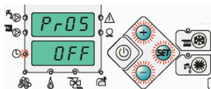
Pr05: Установка работы по времени (таймер)
