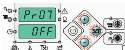
Pr07: Установка программы от замерзания (использовать только при встроенном комнатном термостате)
