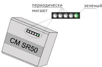
При штатной работе на датчике наполнения горит один зелёный диод, а остальные мигают в зависимости от количества пеллет, которые подаются через гибкую трубку в пеллетную горелку
