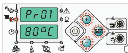
Pr01: Установка температуры котла. Установлено на заводе: 80°C
