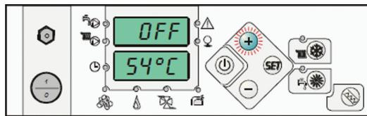
Индикация текущей температуры санитарной воды. Если датчик санитарной воды подключен к пульту управления котла и Pr02 поставлен на «On», при нажатии и удерживании кнопки «+» на нижнем экране в любой фазе работы появляется текущая температура санитарной воды.
