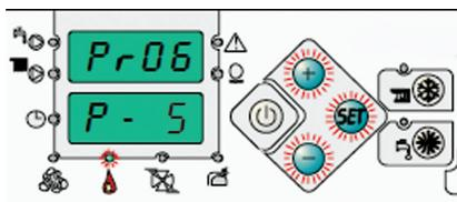
Pr06: Установка мощности горелки CPPL 40-50.
