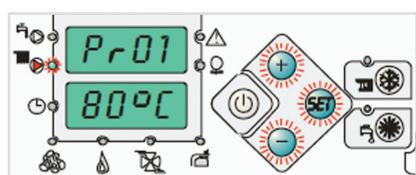
Pr01: Установка температуры котла. Установлено на заводе: 80°C
