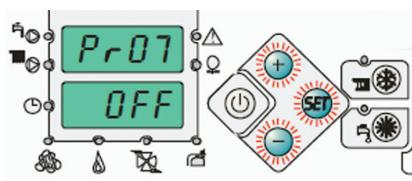
Pr07: Установка программы от замерзания (использовать только при встроенным комнатном термостате)
