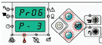
Pr06: Установка мощности горелки CPPL 20-35.
