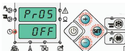
Pr05: Установка работы по времени (таймер)
