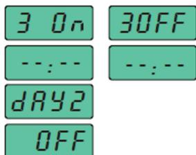
Подпрограмма Pr05: Установка третьего включения/выключения.
