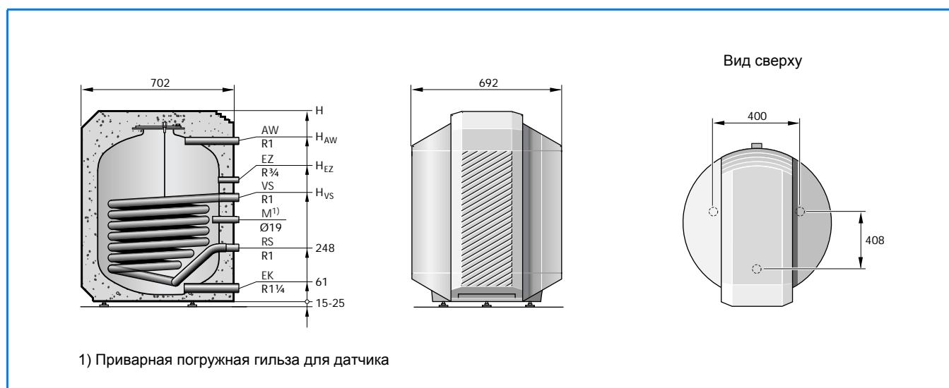
92/1 Размеры вертикальных баков-водонагревателей Logalux ST150 - ST300
